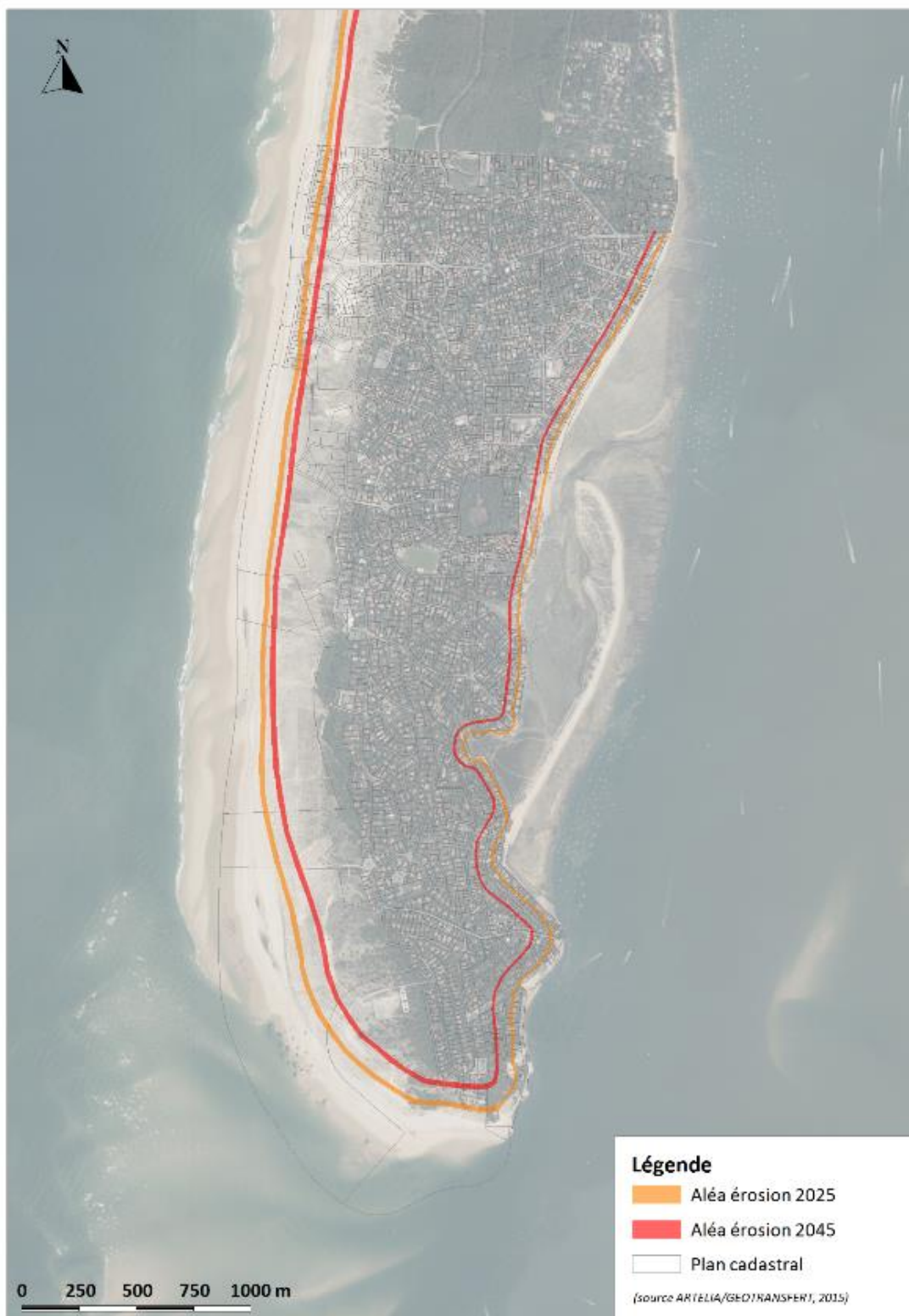
Figure 34. Aléa érosion du trait de côte pour les différents scénarios établis par ARTELIA/GEOTRANSFERT, 2015. Scénario C1 « sans ouvrages actuels + pas d’allongement de la pointe ».
