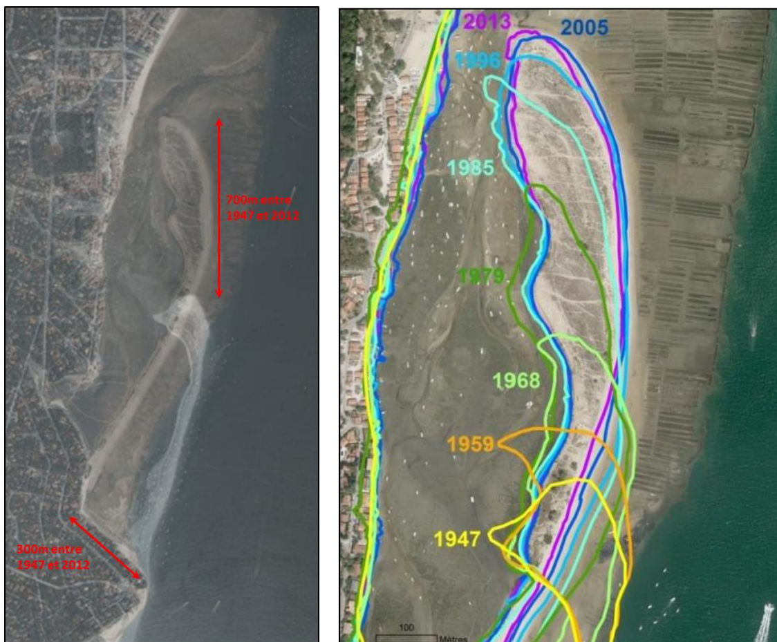
Figure 25. Gauche : superposition des prises de vue aériennes de 1947 et 2012 mettant en évidence les modifications morphologiques de la flèche du Mimbeau (à partir des clichés IGN). Droite : évolution du lobe sommital de la flèche du Mimbeau entre 1947 et 2013 (source : ARTELIA/GEOTRANSFERT, 2015).
