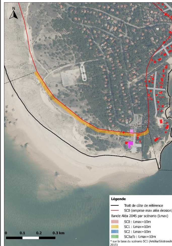
Figure 19 : Projection de l'érosion du trait de côte à 2045 pour le scénario 1 du secteur de la Pointe.
