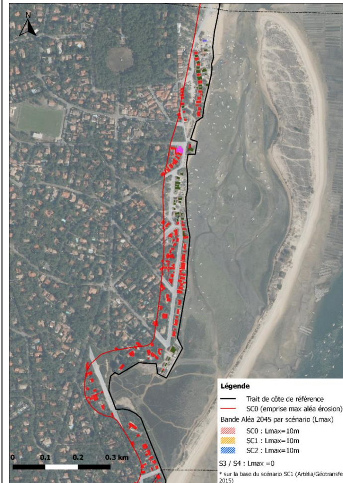
Figure 73 : Projection de l'érosion du trait de côte à 2045 du scénario 3 pour le secteur de la conche du Mimbeau.
