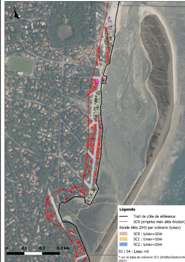
Figure 74 : Projection de l'érosion du trait de côte à 2045 du scénario 4 pour secteur de la conche du Mimbeau.
