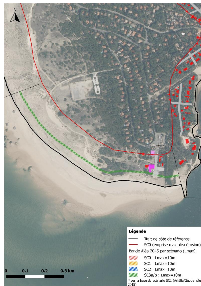
Figure 23 : Projection de l'érosion du trait de côte à 2045 pour le scénario 3a du secteur de la Pointe.
