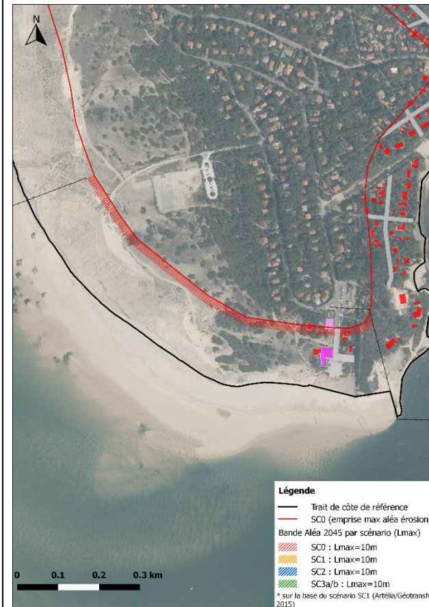
Figure 18 : Projection de l'érosion du trait de côte à 2045 pour le scénario 0 du secteur de la Pointe.
