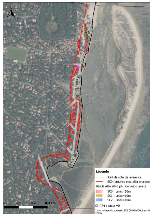
Figure 70 : Projection de l'érosion du trait de côte à 2045 du scénario 0 pour le secteur de la conche du Mimbeau.
