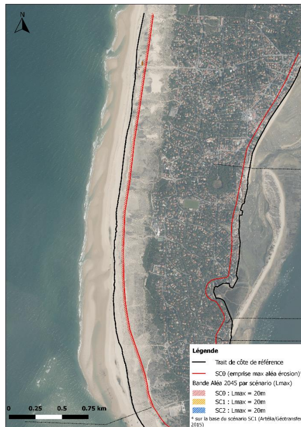
Figure 10 : Projection de l'érosion du trait de côte à 2045 pour le scénario 0-du secteur de la façade océanique.
