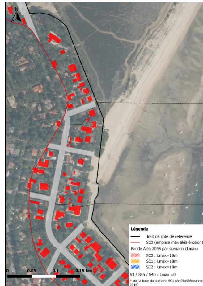
Figure 54 : Projection de l'érosion du trait de côte à 2045 du scénario 4a pour le secteur de la flèche du Mimbeau.
