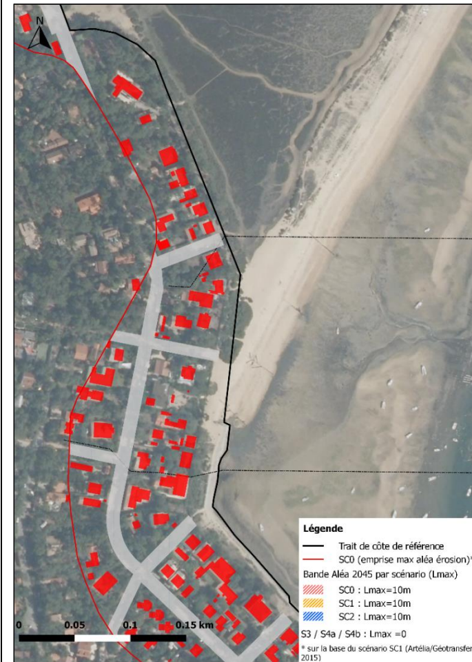
Figure 59 : Projection de l'érosion du trait de côte à 2045 du scénario 3c pour le secteur de la flèche du Mimbeau.
