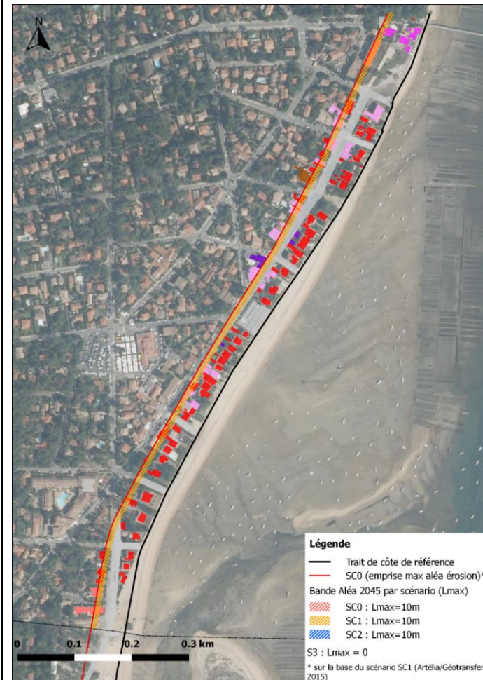
Figure 83 : Projection de l'érosion du trait de côte à 2045 du scénario 1 pour le secteur de Bélisaire.
