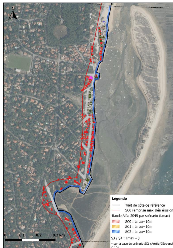
Figure 72 : Projection de l'érosion du trait de côte à 2045 du scénario 2 pour le secteur de la conche du Mimbeau.
