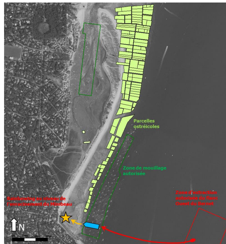
Figure 58 : Schéma de principe du rechargement hydraulique de l'estran de l'enracinement de la flèche du Mimbeau.
