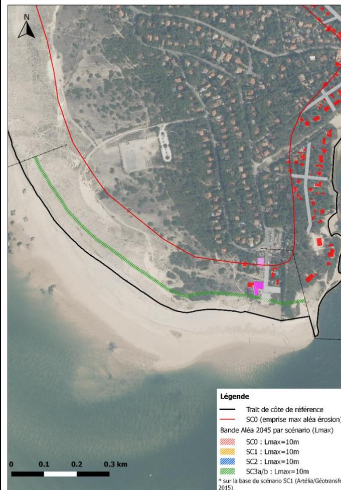
Figure 10 : Projection de l'érosion du trait de côte à 2045 pour le scénario 3b du secteur de la Pointe.
